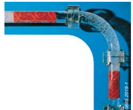
Bild 3: Blasenbett im vertikalen und im horizontalen Sulzer-Mischer SMV-12 DN 50 sowie Phasentrennung im horizontalen Leerrohr; System Luft/Wasser; Strömungsgeschwindigkeit 0.5 m/s.
