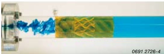
Bild 4: Blaue Farbe wird in der Rohrmittle als Additiv dem Wasserstrom zugegeben. Mit wenigen SMV-Mischelementen wird eine homogene Mischung erzielt.
