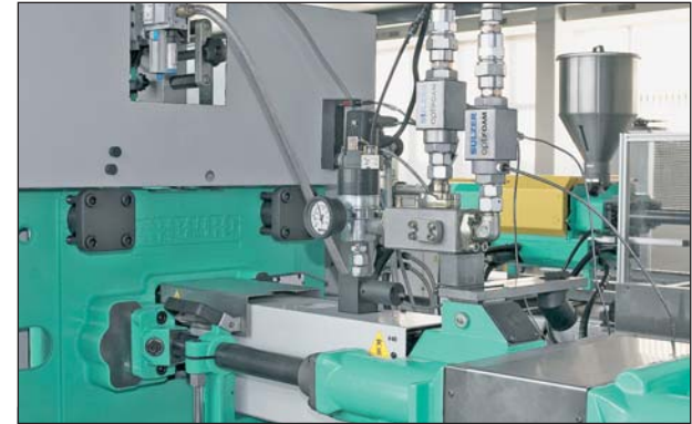
Abb. 3: Optifoam-Komponenten für die Herstellung von Silikonschaum auf einer Arburg-Spritzgießmaschine
